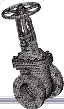
Análisis de tensión y cálculo sísmico en válvulas para centrales nucleares Stress analysis and Seismic calculation for nuclear valves
